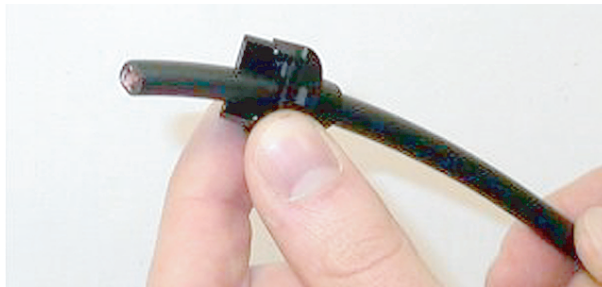
Рисунок 6.69: Задняя часть корпуса на кабеле
