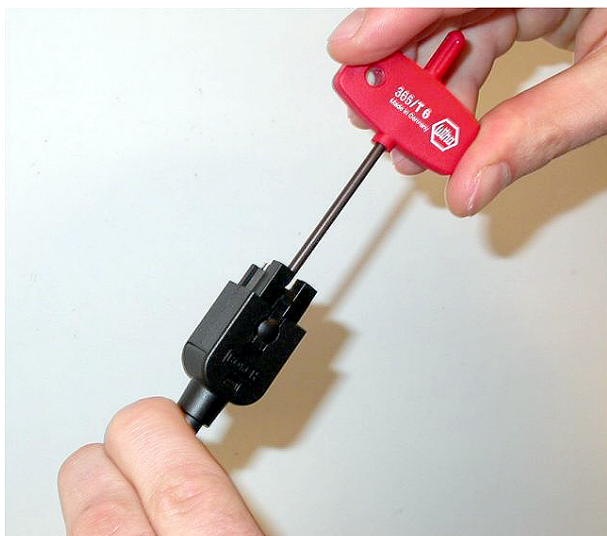
Рисунок 6.100: Затяжка винта Torx
