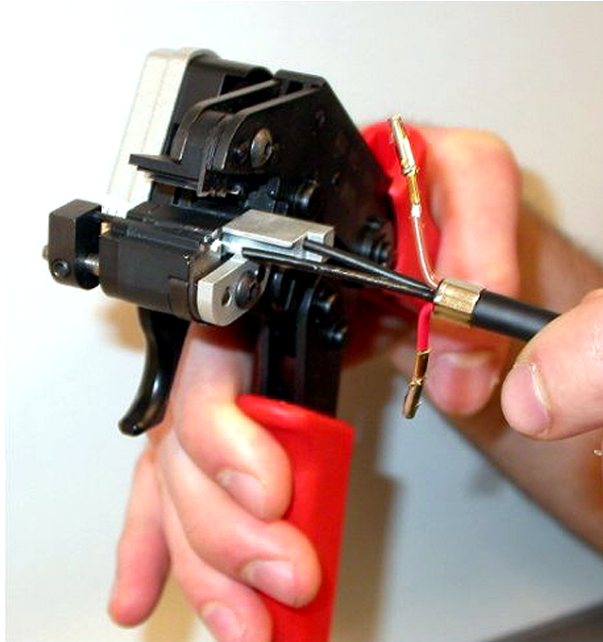
Рисунок 6.79: Обрезка волоконного световода (1)
