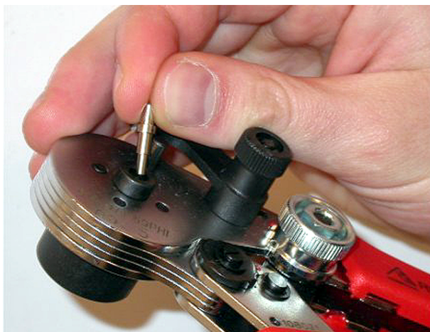
Рисунок 6.84: Вставка обжимного наконечника
