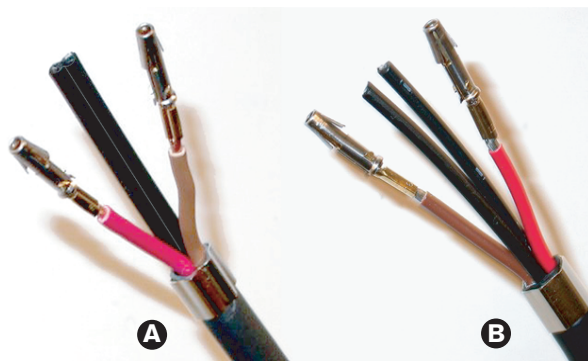
Рисунок 6.78: Смонтированные контакты разъема
